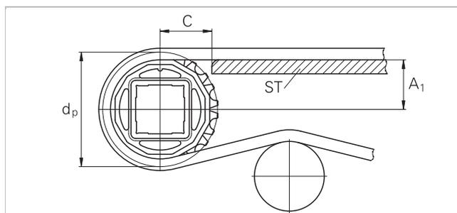
La distanza minima **C** tra l'asse dell'albero e l'inizio del piano di scorrimento **ST** è 53 mm (2,1").
