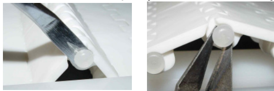
Hebeln Sie den Stabkopf heraus
