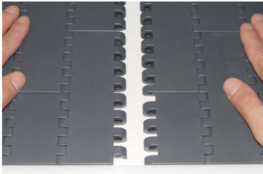
Zusammenfügen der Bandabschnitte
