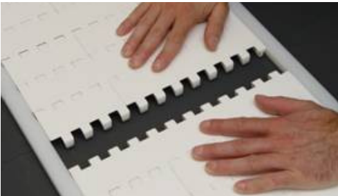
Zusammenfügen der Bandabschnitte
