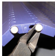
Haga palanca en la cabeza de la varilla para extraerla
