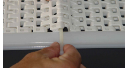
Inserte la varilla. La varilla puede instalarse más fácilmente si el extremo está biselado.
