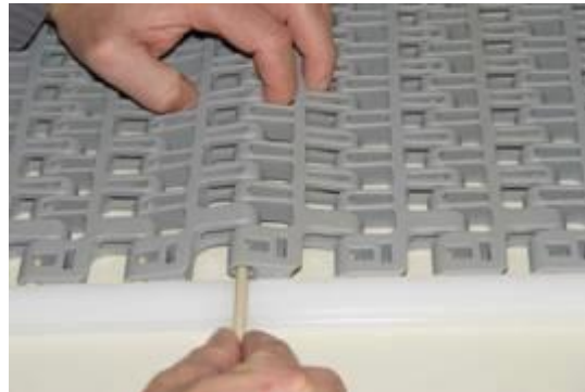
Inserire il perno. Per agevolare l'installazione, l'estremità del perno deve essere smussata.
