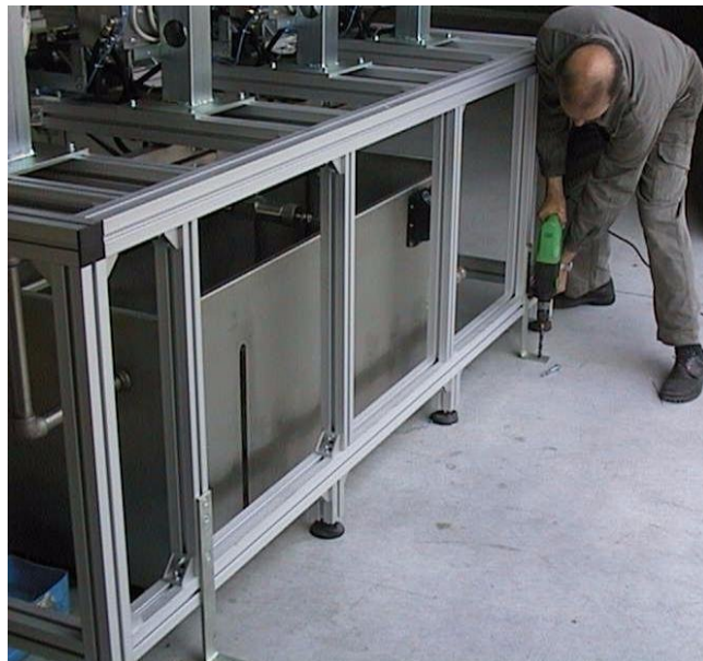
ABBILDUNG 6 – BEFESTIGUNG DES GRUNDRAHMENS (2)
