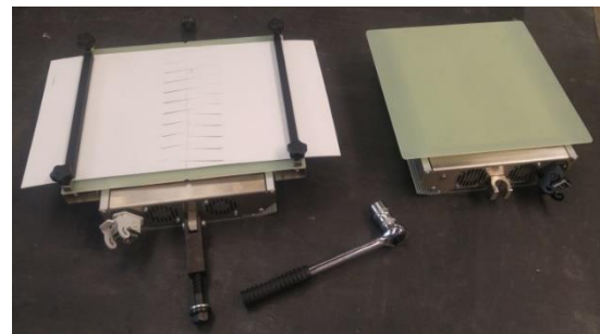
Fig. 8-4 - Posizionamento nastro Fabric su piastra di giunzione
