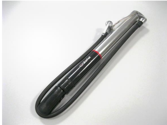
MANUELLE PUMPE ZUM AUFBLASEN DES KISSENS WIRD AN DAS SCHRADER-VENTIL AUF DER QUERSTANGE DER UNTEREN PRESSE ANGESCHLOSSEN
