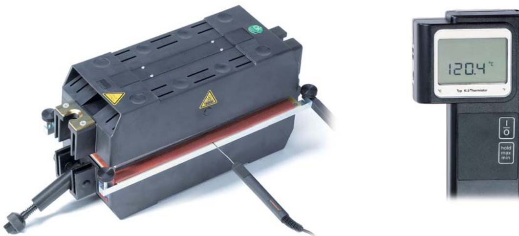
Fig. 1: Mesure de la température de la plaque chauffante
