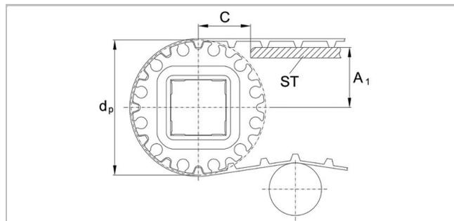
La distancia **C** entre el eje del piñón y el soporte de deslizamiento **ST** es de por lo menos 28 milímetros (1,1").
