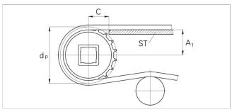
La distancia C entre el eje del piñón y el soporte de deslizamiento ST es de por lo menos 28 milímetros (1,1").
